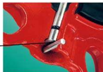
Čep pojištěný kolíkem umožňuje demontáž
